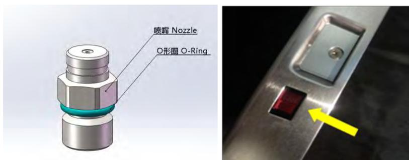
5. Alimentation d'entrée commutable, entre 110 V et 220 V comme indiqué sur l'image ci-dessus (la tension est affiché dessus). L'alimentation électrique est située sur le côté de la commande électrique, et vous devez retirer le couvercle avant de commuter
